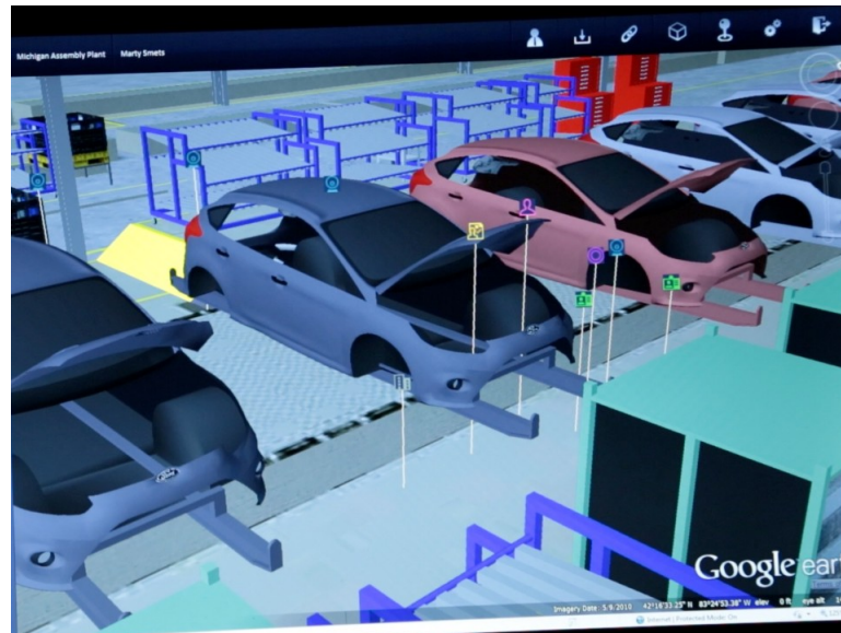
Figura 1 – Exemplo de visualização do IntoSite da Ford, com modelo tridimensional virtual de uma planta de produção. Retirado de (FORBES, 2014)
